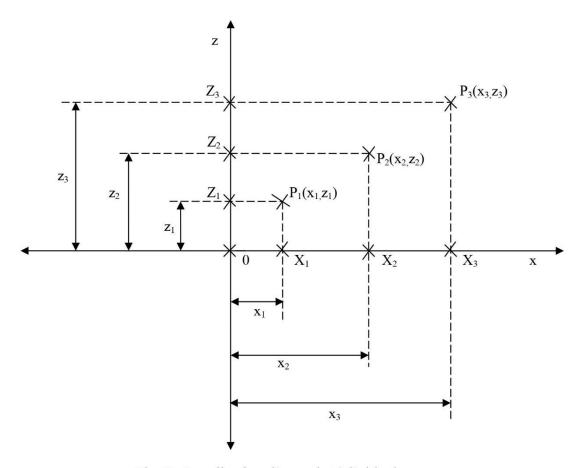
Fig. 2. Localisation d'un point à l'aide des axes
