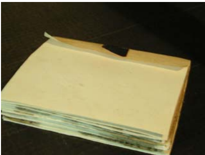
Fascicolele completate, înainte de copertare, învelitor intermediar
