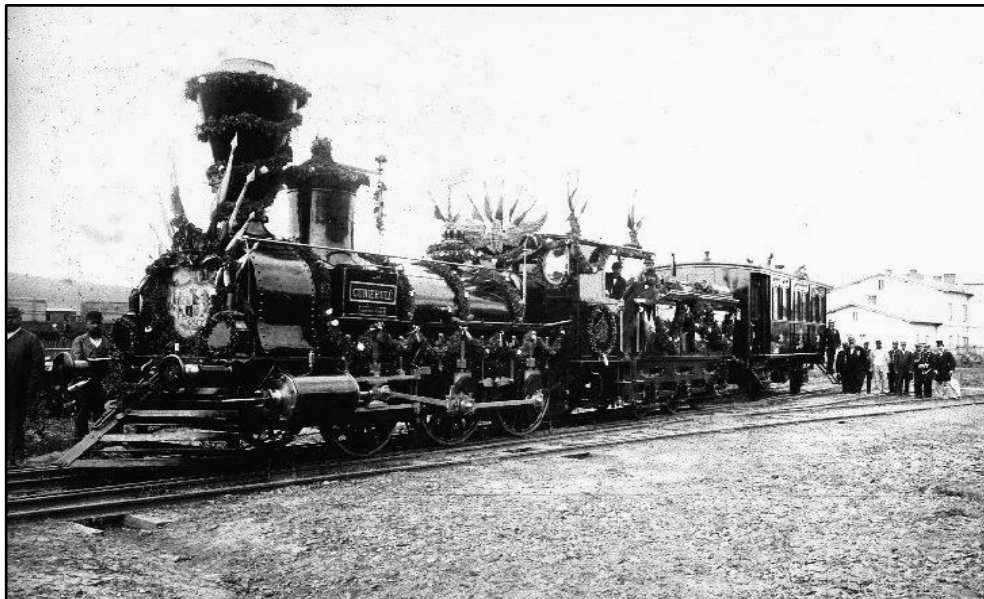
Locomotiva LCJE 56, tip 1B n2, Canada Works, Birkenhead, care, la 15 decembrie 1869, a remorcat trenul inaugural al liniei Suceava – Roman. Sursa: https://www.facebook.com/145-ani-de-drum-de-fier-prin-gara-Pascani
