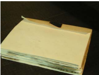
Fascicolele completate, înainte de copertare, învelitor intermediar
